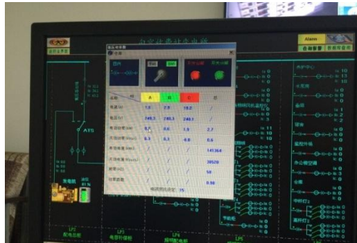
图注：搭建能耗统计管理系统
