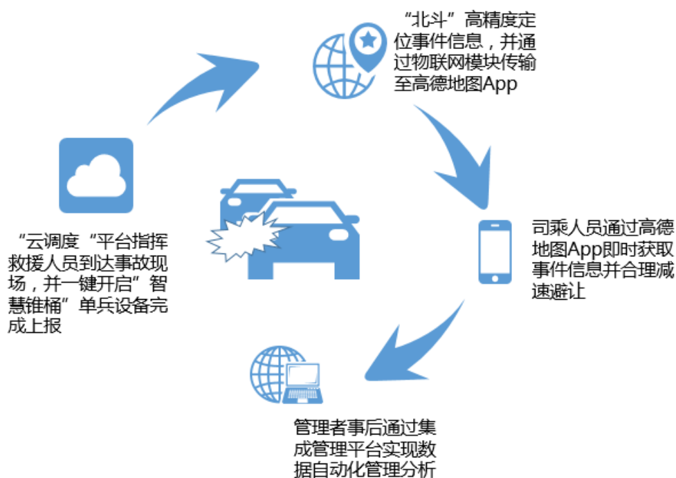
图注：高速公路物联网智慧警示系统
